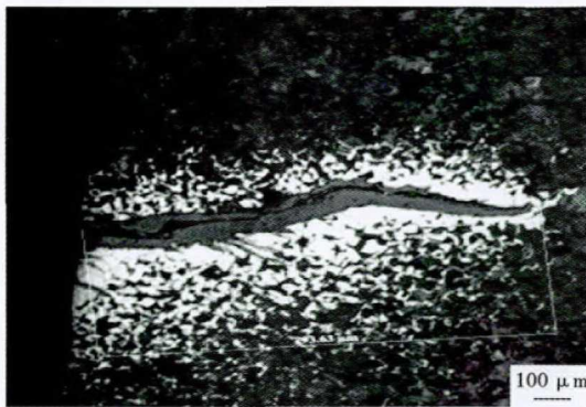
图 3 钢球钢轧材表面裂纹处组织形貌(深度:0.79 mm)
